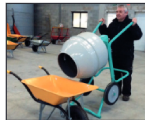
Descarga directamente sobre una carretilla de obra.
